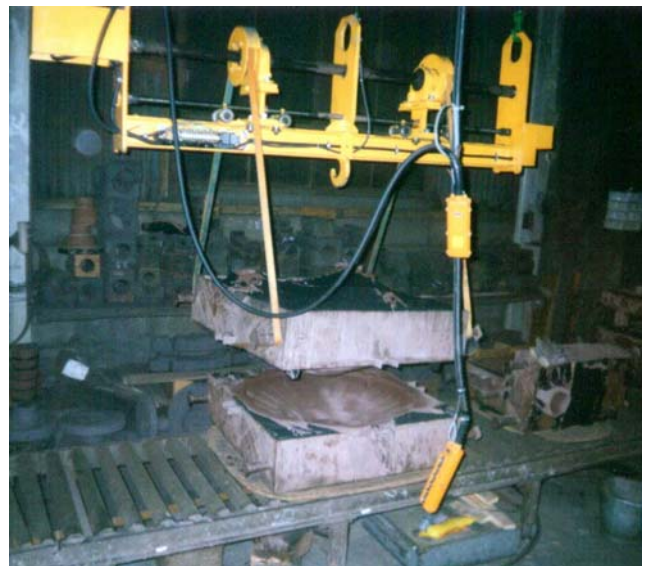
鋳物工場で鋳型の反転に使用
