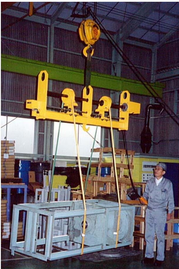
機械工場で重量物の反転に利用
